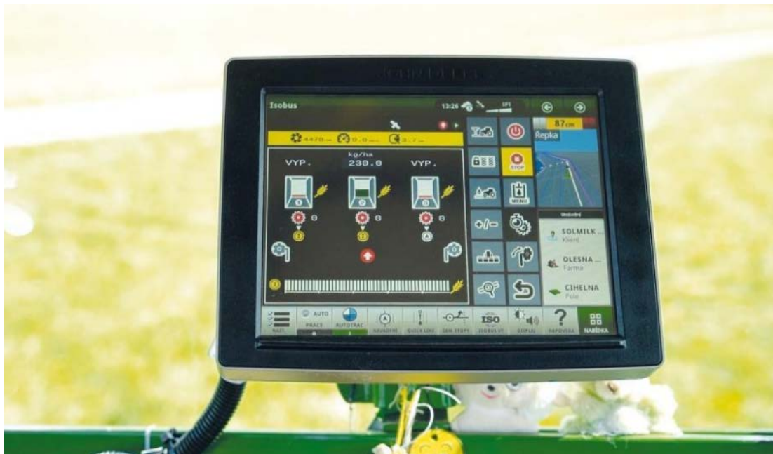
Рис. 2. Інтерфейс користувача автоматичного керування сівалкою
