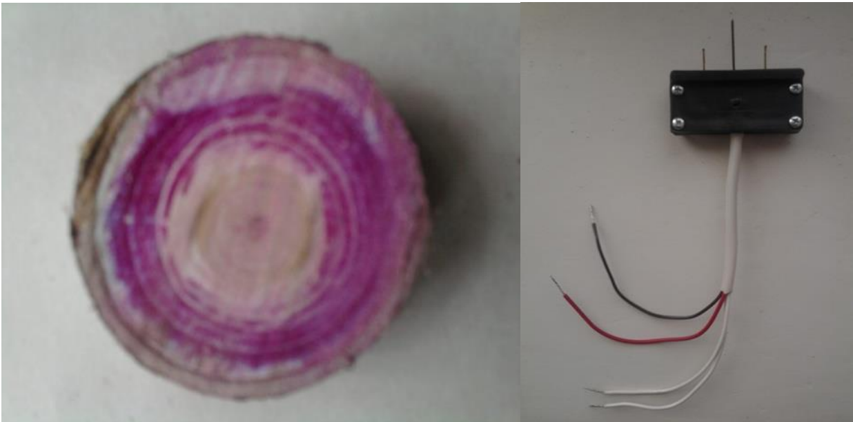
а) б) Рисунок 1. Загальний вид зрізу штамбу черешні (а) і датчика індексу ксилемного потоку (б).
