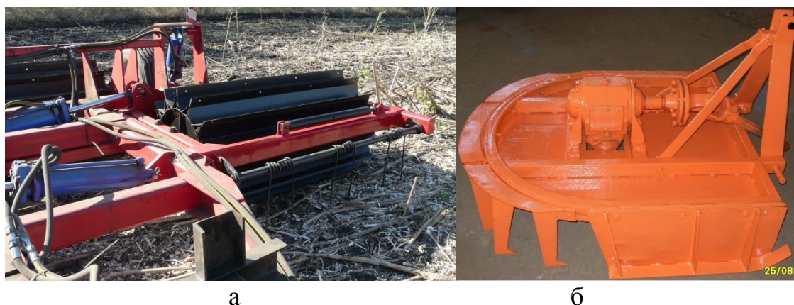
Рис. 1. Подрібнювачі рослинних решток, розроблені науковцями кафедри сільськогосподарського машинобудування КНТУ: а – коток-подрібнювач КП-4,5; б – подрібнювач рослинних решток ПН-1,5;
