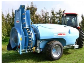
Рис. 1. Приставка з осьовим вентилятором з двома пропелерами, що обертаються в протилежних напрямках
