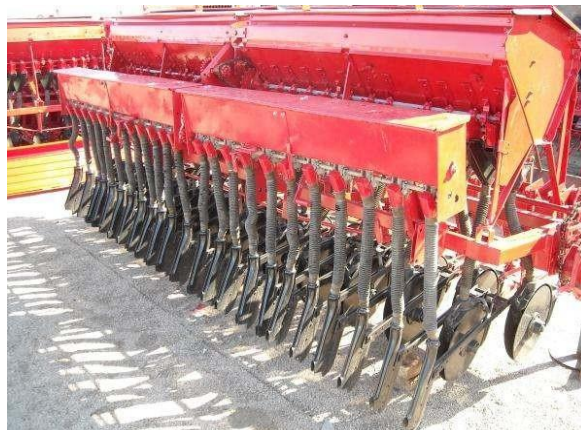
Рис. 3. Загальний вигляд сівалки СЗТ–3,6А
