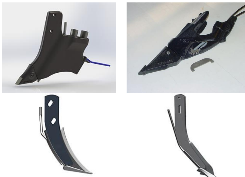
Рис.1. Ножі для внесення кількох видів різних добрив під час нарізання стрічок.
