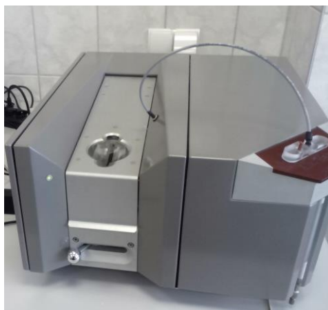
Рис. 1. Фото приладу Mixolab (Франція).
